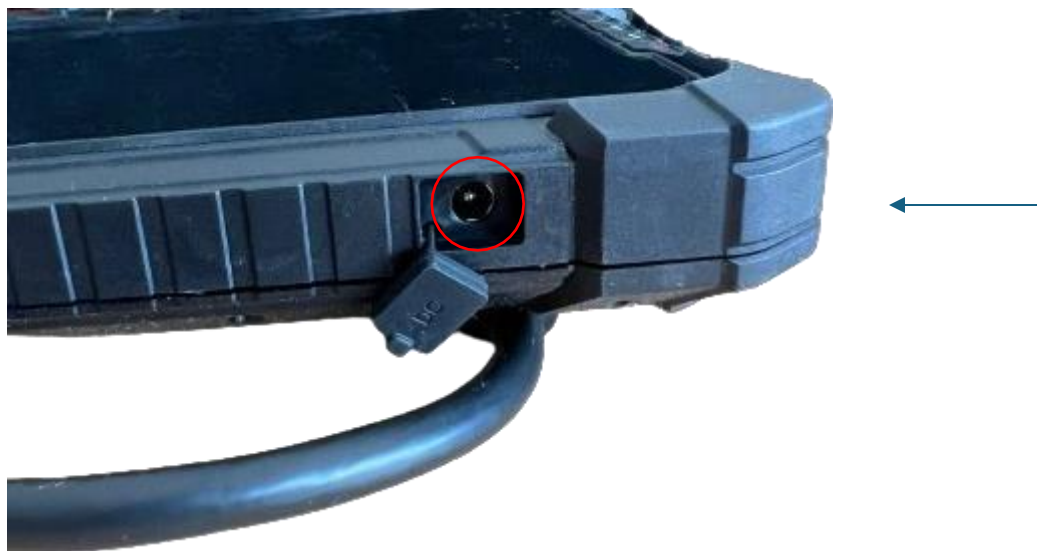
Fig. 4 - Connettore di alimentazione dispositivo BR001
