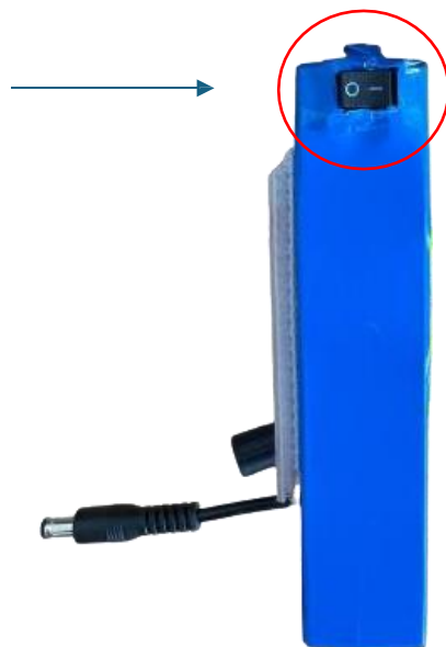
Fig. 2 - Interruttore batteria di emergenza
